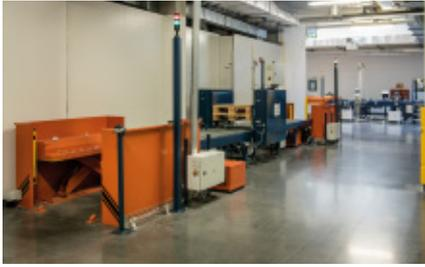
En la salida del almacén se recopilan palets vacíos, que se amontonan luego en la zona de entrada, donde se ha instalado un apilador de palets. El objetivo es disponer de palets para las unidades de carga procedentes del exterior de fabricación que no cumplan con las especificaciones del almacén y tengan una base inadecuada. En esta situación, se colocan encima de un palet para garantizar la resistencia de las cargas y su estabilidad en el circuito e interior del almacén.
